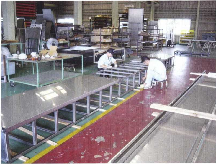
大型自立サインの工場内製作
