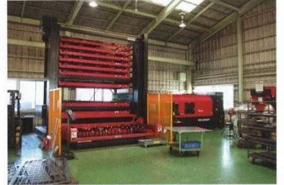
金属板を保管し、電動で出し入れができる材料棚付レーザー加工機
