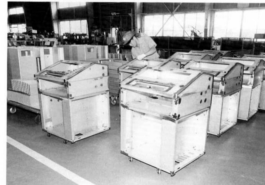
ラインプリンタの筐体。日本ゲージの高度な加工技術が伝わってくる
