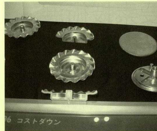
スピーカーの放熱板の工法転換例(写真中央)。アルミダイキャスト+溶接から順送機による2部品一体加工に成功した。材質はA1050で板厚は1.5mm。 南日伸精工( http://www.nisshin-seiko.co.jp )
