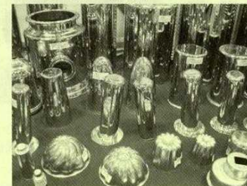
超薄物プレス加工では板厚8μmからのプレス加工が可能。材厚公差プラスマイナス5μmという高精度を誇る。金型の設計製作、プレス加工、表面処理までを一貫生産。 株ミスズ工業( http://www.miszu.co.jp )
