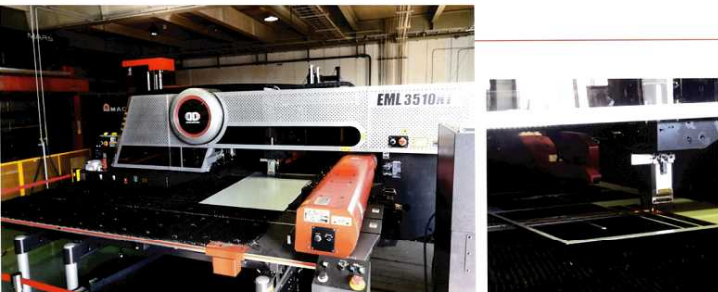
2013年6月に導入したパンチ・レーザ複合マシンEML-3510NTPが自動倉庫MARSと連携し、24時間稼働に対応する
