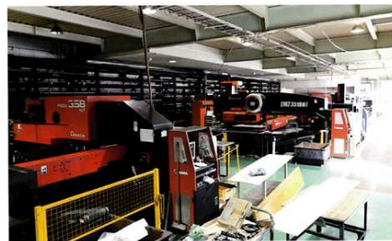
同社のパンチング工程。EMLのほか、パンチマシンPEGA-358NT×2台とEMZ-3510NTPの計4台が自動倉庫MARSと連携する
